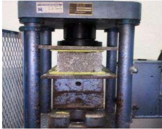
Figura.11.2. Prueba a la compresión simple.
