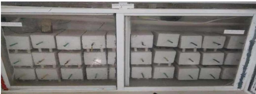
Se diseñó una cámara de carbonatación acelerada, se desarrolló de material acrílico, en ella se instalaron 2 calentadores eléctricos, 2 pequeños ventiladores, tubos de PVC para que en ella fluyera el CO<sub>2</sub>, y recipientes con contenido de zeolita, para que se pudiera tener un mejor control de la humedad relativa, la temperatura y CO<sub>2</sub>.
