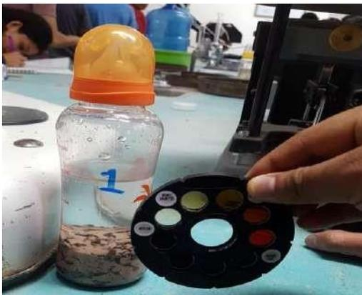
**Fig.8.1 Prueba de determinación de impurezas orgánicas**
