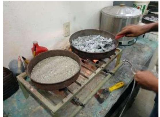
**Fig. 2- contenido de humedad total de los agregados por secado**
