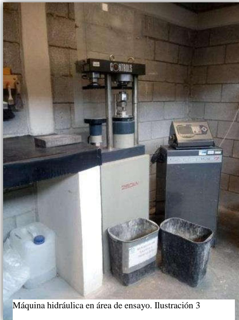
Máquina hidráulica en área de ensayo. Ilustración 3
