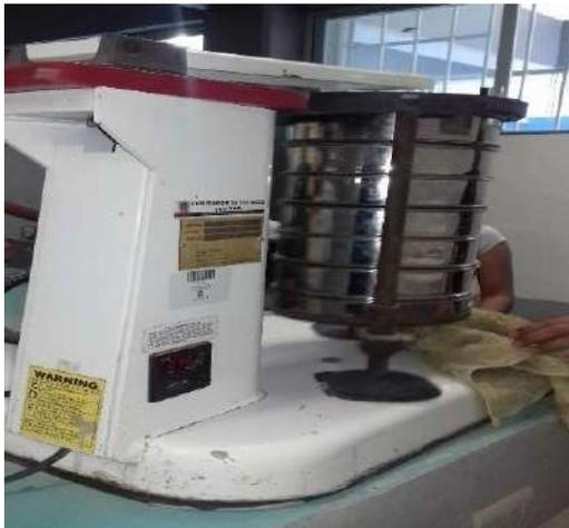
**Fig.5. Prueba de Granulometría.**
