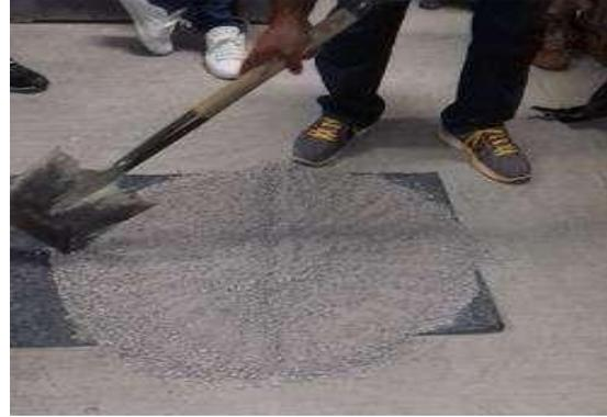
**Figura 2.1. Método de cuarteo de la muestra.**
