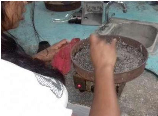
**Fig.3.1. Contenido de humedad total de los agregados por secado**
