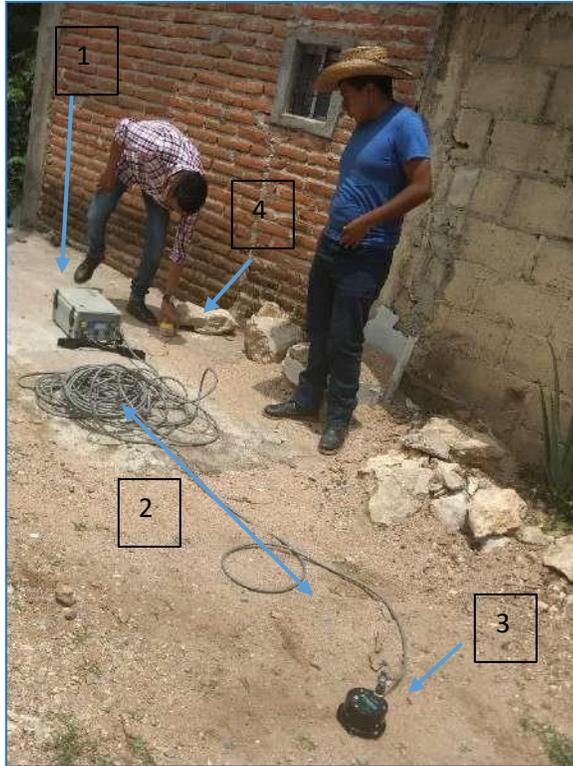
Fig. 2 Instalación de un acelerógrafo.
