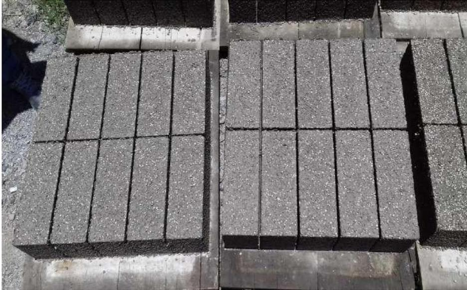
**Fig.10. Transporte de la tarima y descarga en el lugar de fraguado.**
