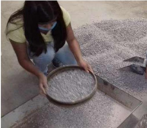
**Figura 6.1. Prueba de separación de material en greña**
