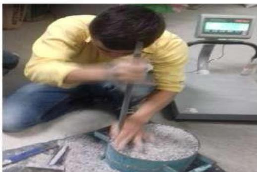
**Figura 4.2. Prueba de peso volumétrico compactado. Establecido en la NMX-C-073**
