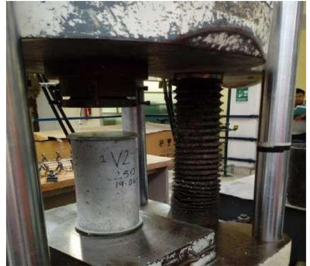
Fig. 10 Ensayo de cilindros en la prensa hidráulica
