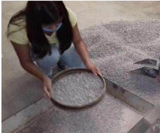
**Fig. 3. Separación de material en greña.**
