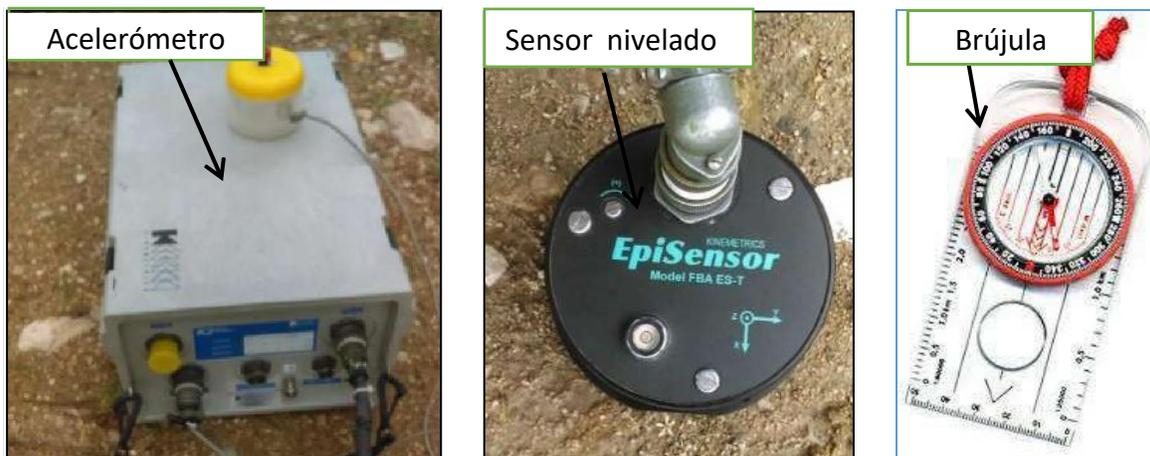
Figura 2. Acelerómetro, sensor y brújula
