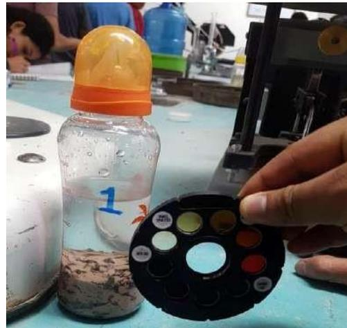
**Fig. 6. Determinación de impurezas orgánicas.**
