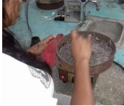
**Fig. 2. Determinación de contenido de humedad total.**
