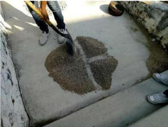
**Figura.1- Método de cuarteo de la muestra.**
