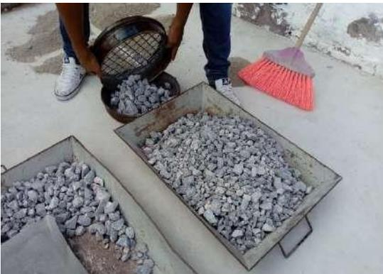
**Figura 3- Prueba de separación de material en greña**
