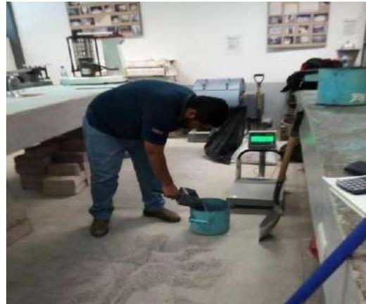
**Fig. 4. Prueba de peso volumétrico.**
