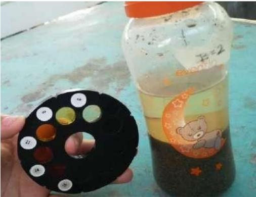
**Fig. 8- Prueba de determinación de impurezas orgánicas**
