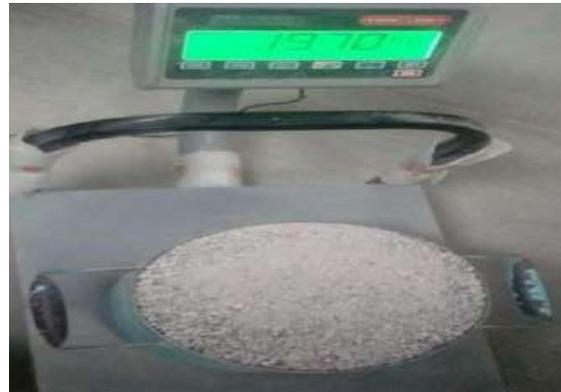
**Figura 4.1. Prueba de peso volumétrico suelto. Establecido en la NMX-C- 073**
