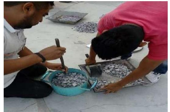
**Figura 4 – prueba de peso volumétrico compactado. Establecido en la NMX-C-**
