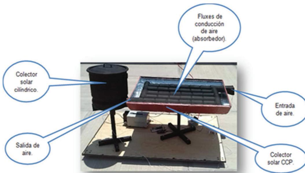
Figura 3. Calentador solar de aire continuo
