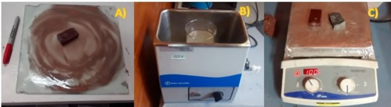
Figura 7. A) Sección siendo desgastada. B) Ultrasonido el cual sirvió para liberar las láminas de los abrasivos. C) Plancha eléctricas donde se están secando las muestras a una temperatura de 100 ° C.
