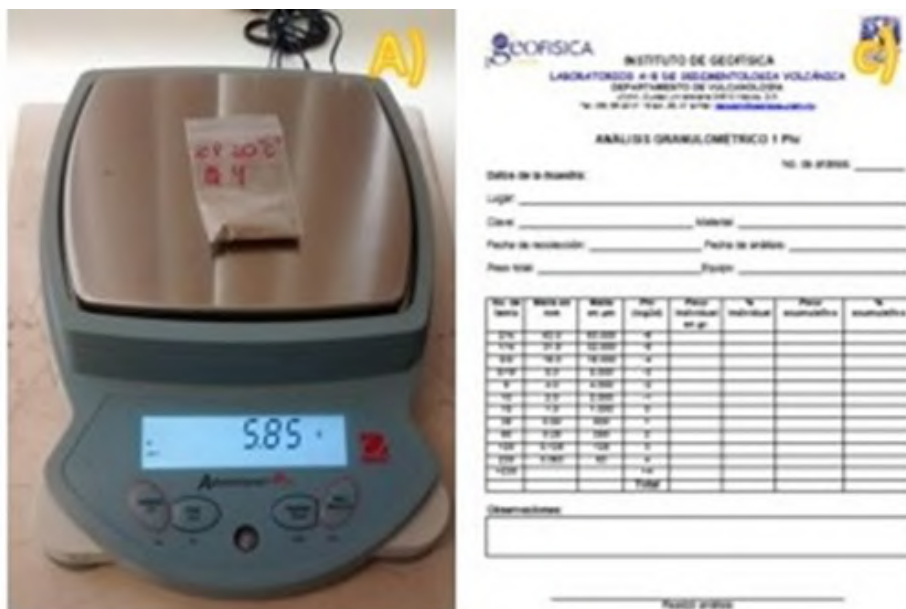
Figura 9. A) Báscula de precisión utilizada para la obtención del peso de las muestras. B) Formato el cual fue llenado con el peso de las muestras
