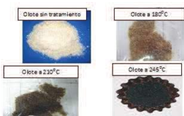
Figura 1. Comparación del olote sin tratamiento, con el tratado a 180°C, a 210°C y a 245°C.
