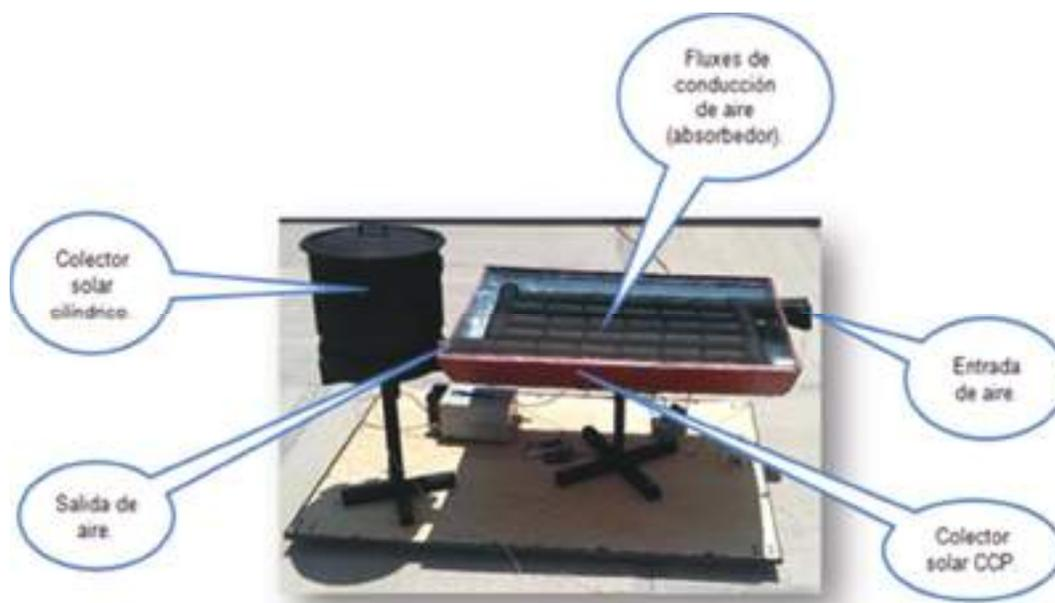
Figura 3. Calentador solar de aire continuo
