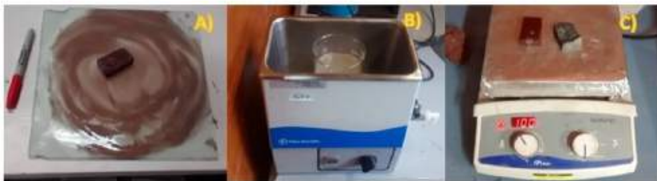
Figura 7. A) Sección siendo desgastada. B) Ultrasonido el cual sirvió para liberar las láminas de los abrasivos. C) Plancha eléctrica donde se están secando las muestras a una temperatura de 100 ° C.
