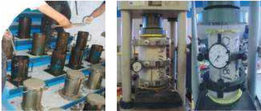
**Figura 1.** Muestreo, instrumentación y ensaye de cilindros de concreto
