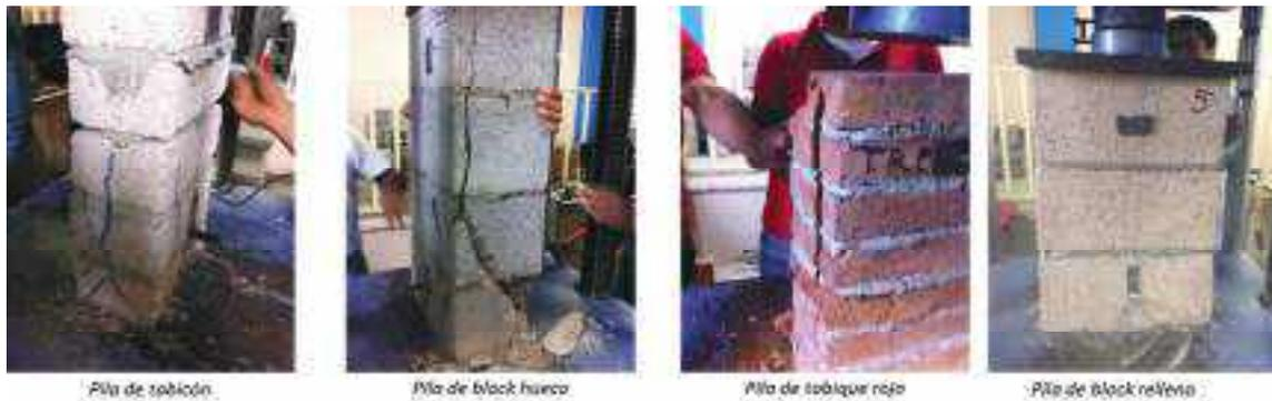
En cuanto a la resistencia y durabilidad de los materiales usados en la construcción de vivienda de interés social, se determinaron estos parámetros con las pruebas que se realizaron a distintos materiales, lo que nos arrojó información acerca de la calidad de las construcciones y sirvió para tener con certeza la fiabilidad de las construcciones realizadas.
