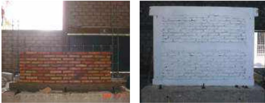
**Figura 1.** Proceso constructivo del muro de mampostería confinada con dala intermedia
