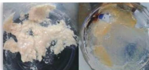
Fig. 4. Izquierda, muestra una pasta formada por ranitidina, Parteck M2000 y alcohol. Derecha la mezcla después se someterse a calentamiento.
