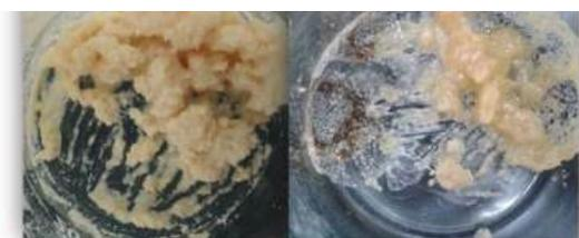
Fig. 3. Izquierda, muestra una pasta formada por ranitidina, PVP K30 y alcohol. Derecha la mezcla después se someterse a calentamiento.
