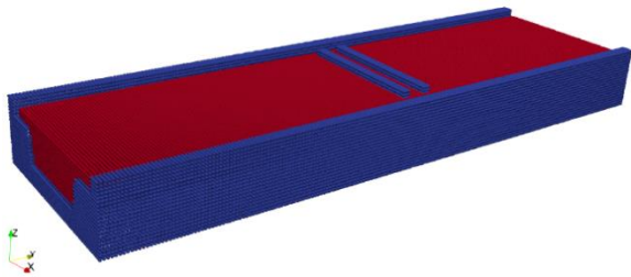
Figura 3. Condición inicial de la simulación computacional, en azul se muestran el canal y el puente que representan un material sólido homogéneo, en rojo el fluido que representa el agua.
